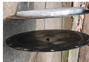
图 5 泡沫覆盖圆钢板与光面圆钢板照片
