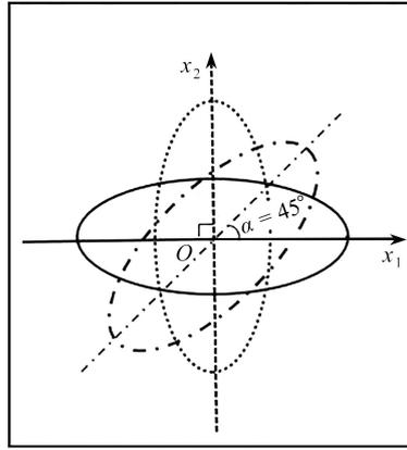
图 8 椭圆孔旋转构型
