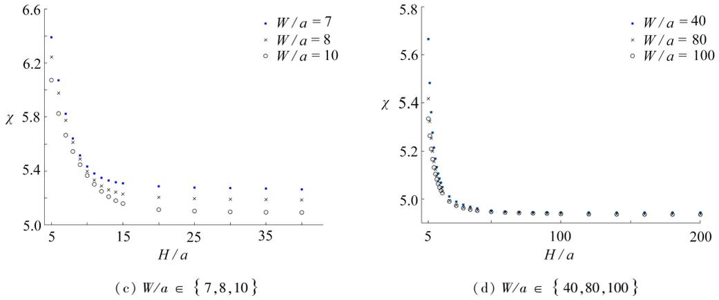
图3 声子场应力集中系数随板尺寸的变化
