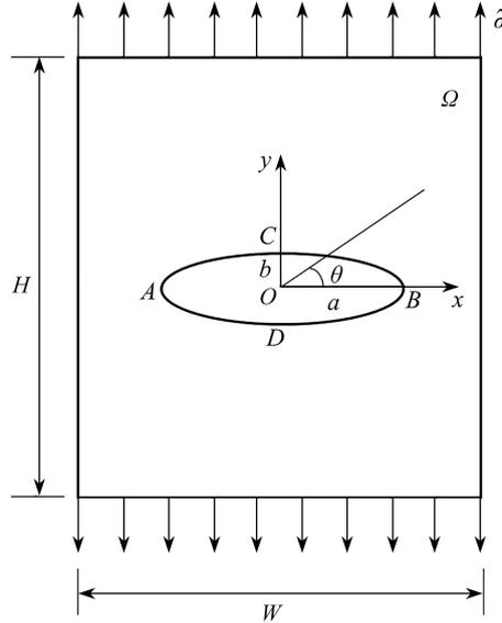
图2 含椭圆孔的试样
