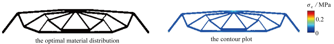
图5 基于经典弹性理论的应力最优拓扑结构
