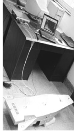
图 4 飞行器结构模型频率测试试验现场
