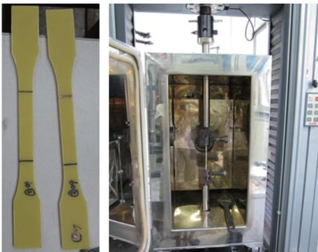
图 3 拉伸实验试样及仪器
