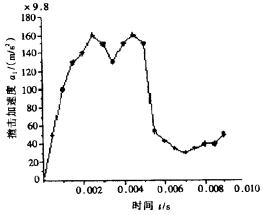
图 13 头颅撞击弹性板的试验曲线
