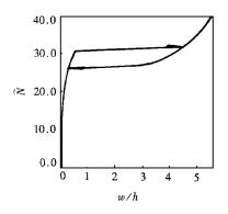
图 9 k = 25 的(90/0/90/0) 曲板在 S4S4 边界条件下, 板中央量纲一挠度与 量纲一压力的关系曲线
