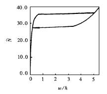
图 10 k= 25 的(90'0'90'0) 曲板在 S4S2 边界条件下, 板中央量纲一挠度与 量纲一压力的关系曲线
