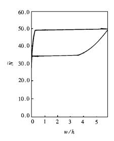
图 16 k=25的(90/0)<sub>10</sub>曲板在 S4S2 边界 条件下,板中央量纲一挠度与量纲一 压力的关系曲线
