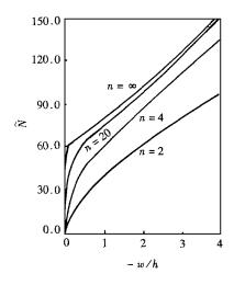
图 14 k = 25 的 $(0/90)_{n/2}$  ( $n = 2, 4, 20, \infty$ ) 曲板在 S4S2 边界条件下, 板中央量纲一挠度与量纲一压力的关系曲线
