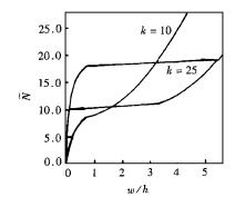
图 3 (90'0) 曲板( k= 10,25) 在 S4S2 边界条件下, 板中央量纲一的挠 度与无量纲压力的关系曲线
