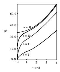
图 13 (0/90) n/2(n=2,4,20,∞) 平板在 S4S2 边界条件下,板中央量纲一 挠度与量纲一压力的关系曲线
