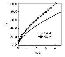
图 11 k= 25 的(0/90)曲板在 S4S2 和 S4S4 边界条件下,板中央量纲 一挠度与量纲一压力的关系曲线
