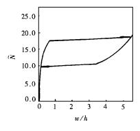
图 8 k= 25 的(90'0) 曲板在 S4S2 边界 条件下, 板中央量纲一挠度与量纲 一压力的关系曲线
