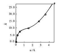
图 6 k= 10的(90/0)曲板在 S4S2与 S4S4 边界条件下,板中央量纲一挠度与量纲 一压力的关系曲线(-S4S2;□S4S4)
