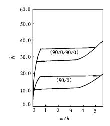
图 15 k= 25 的(90/0)和(90/0/90/0)曲板 在 S4S2 边界条件下,板中央量纲一 挠度与量纲一压力的关系曲线
