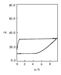
图 4 (90/0) 曲板(k=35) 在 S4S2 边界条件下, 板中央量纲一挠 度与量纲一压力的关系 曲线
