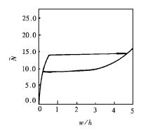
图 7 k= 25 的(90'0) 曲板在 S4S4 边界条件下, 板中央量纲一挠 度与量纲一压力的关系曲线
