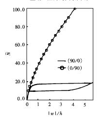
图 12 k= 25 的(90/0)和(0/90)曲板在 S4S2 边界条件下,板中央量纲一挠度与量纲 一压力的关系曲线
