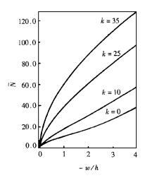
图 5 k= 0, 10, 25, 和 35 的(0/90) 曲板 在 S4S2边界条件下, 板中央量纲 一挠度与量纲一压力的关系曲线
