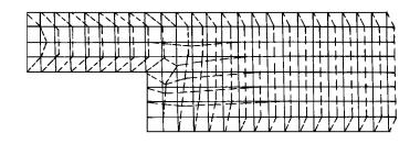
图 2 接点上的质点运动速度矢量的终点 按有限元网格的规则连接示意图
