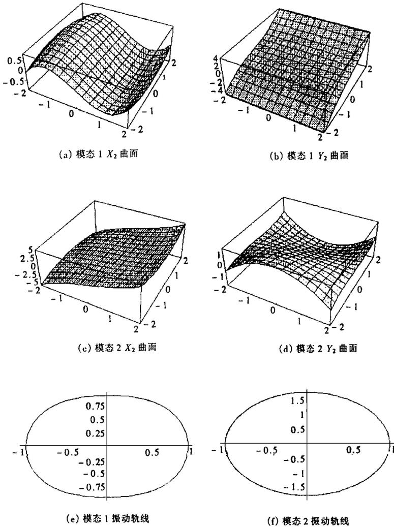
图 2 ((a), (b), (c), (d) 为模态 1、2 的不变非线性模态表面, (e), (f) 为模态振动轨线图)
