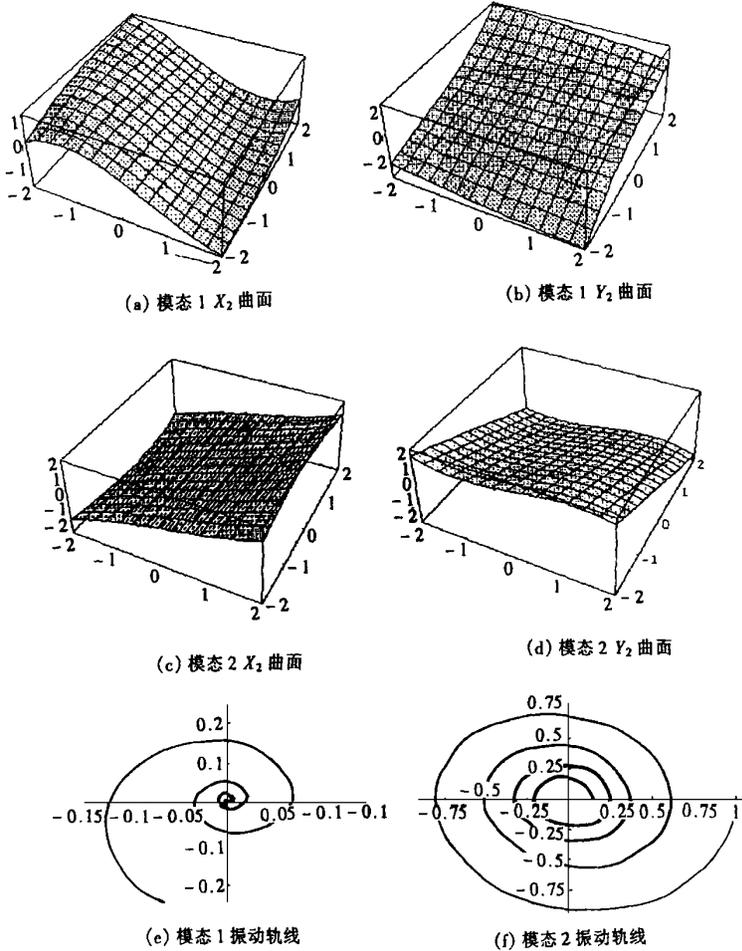
图 3 ((a), (b), (c), (d) 为模态 1、2 的非线性不变表面, (e), (f) 为模态振动轨线图)
