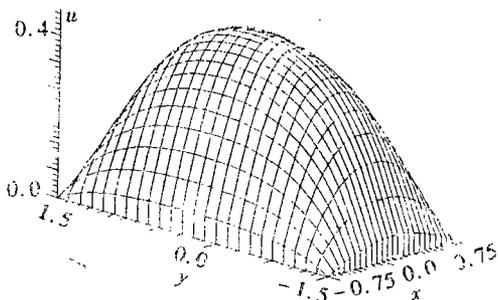
图5  $\delta=2$ 直管流动轴向速度分布
