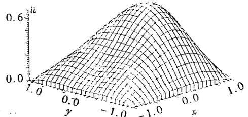
图2  $\delta=1$ ,  $Dean=80$ 时二次流流函数 $\psi_1$ 及轴向速度 $w$
