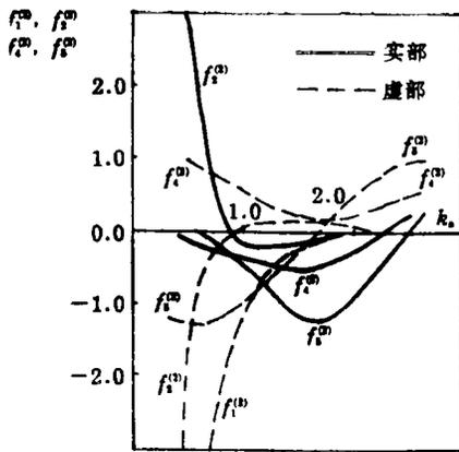
图4 二阶倍频力分量 ( $f_1^{(2)}$ ,  $f_2^{(2)}$ ,  $f_4^{(2)}$ ,  $f_3^{(2)}$ )
