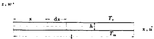
图1 两端固定 Timoshenko 梁的几何模型
